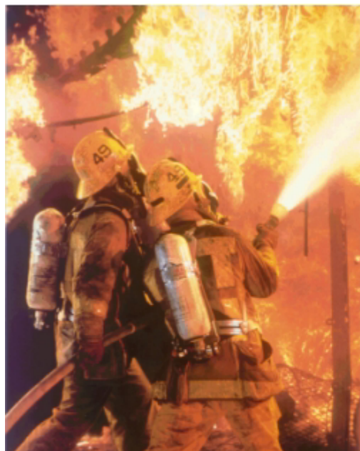
Figure 2.27 Exemple d'utilisation d'un appareil de protection respiratoire autonome en situation d'incendie (gracieuseté de Survivair)
