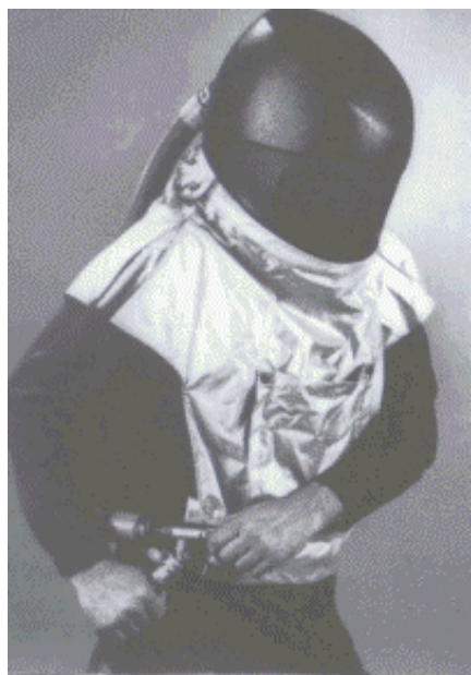
Figure 2.26 Exemple d'appareil de protection respiratoire pour le nettoyage au jet abrasif de type CE (gracieuseté de MSA)
