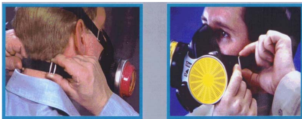
Figure 4.1 Ajustement des brides d'un demi-masque (gracieuseté de MSA)
